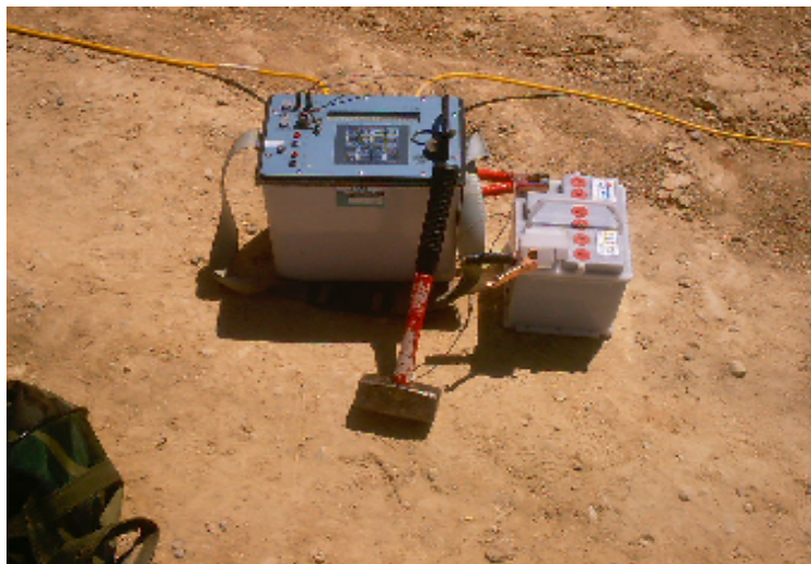
Σχήμα 2.5. Όργανο λήψης ηλεκτρικών μετρήσεων SYSCAL Jr. Switch 48 (v. 11.4++) της εταιρείας IRIS INSTRUMENTS.
