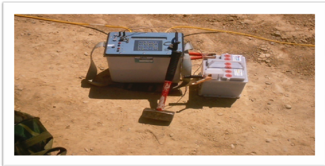
Σχήμα 2.5. Όργανο λήψης ηλεκτρικών μετρήσεων SYSCAL Jr. Switch 48 (v. 11.4++) της εταιρείας IRIS INSTRUMENTS.
