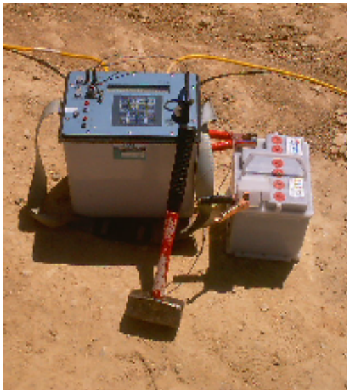
Σχήμα 2.5.: Όργανο λήψης ηλεκτρικών μετρήσεων SYSCAL Jr. Switch 48 (v. 11.4++) της εταιρείας IRIS INSTRUMENTS
