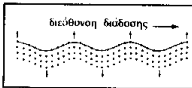
Σχήμα 11 Κινήσεις των υλικών σημείων κατά τη διάδοση εγκάρσιου κύματος.
