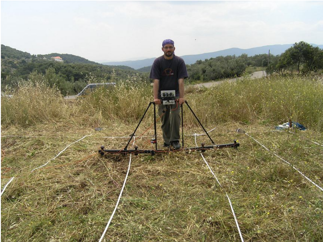
Σχήμα 2.7 Χαρτογράφηση αρχαιολογικού χώρου με την μέθοδο της ειδικής αντίστασης
