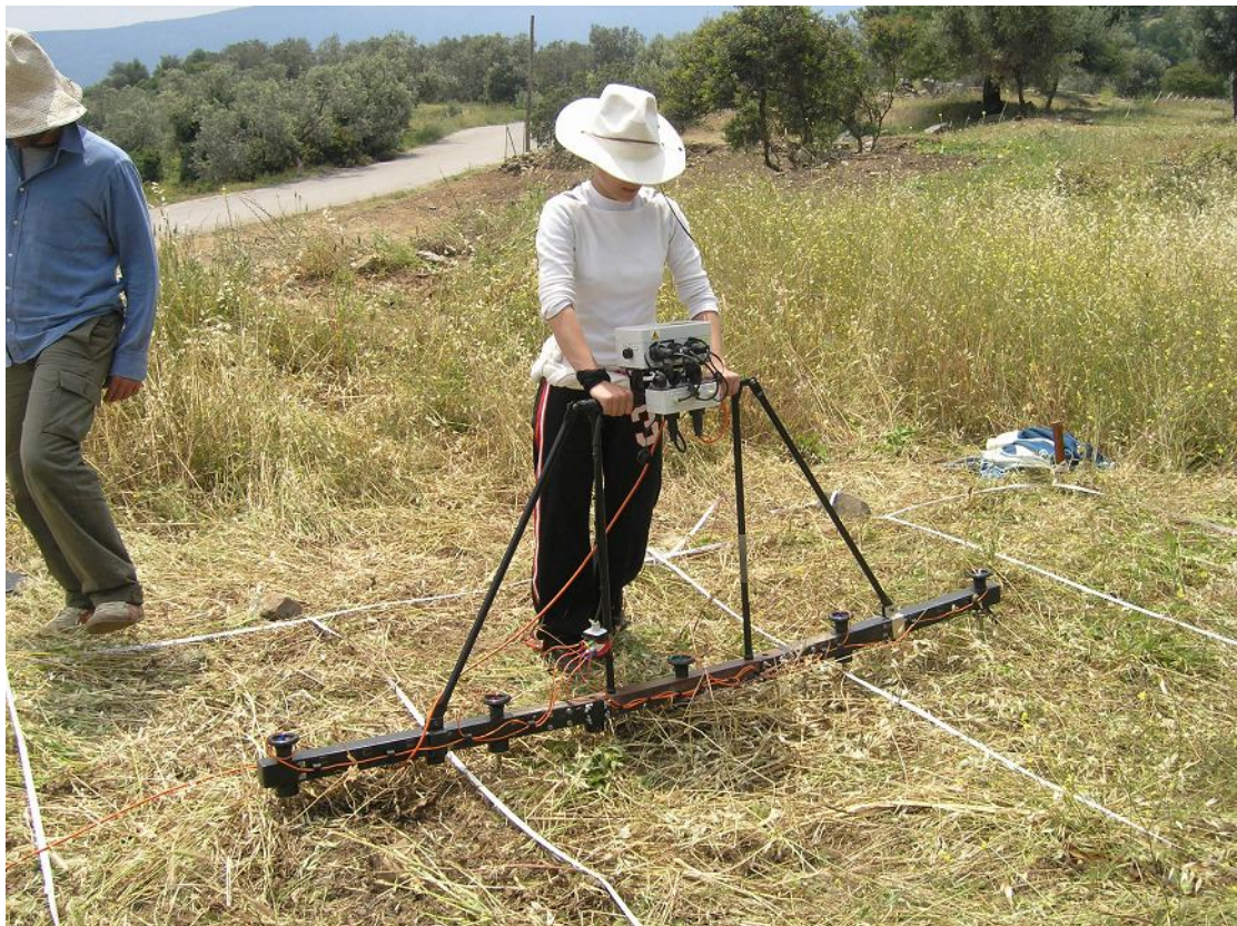
Σχήμα 2.3 Χαρτογράφηση αρχαιολογικού χώρου με την μέθοδο της ηλεκτρικής αντίστασης
