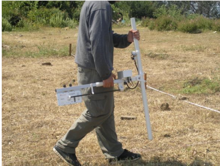
Σχήμα 3.2 Το μαγνητόμετρο GRAD 601 fluxgate gradiometer
