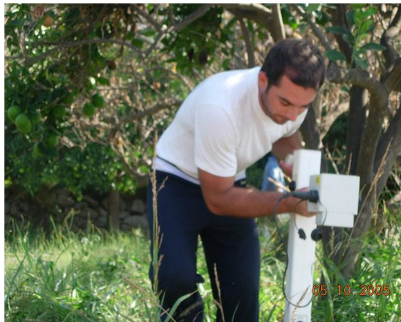
Σχήμα 3.1 Το μαγνητόμετρο FM 256 fluxgate gradiometer
