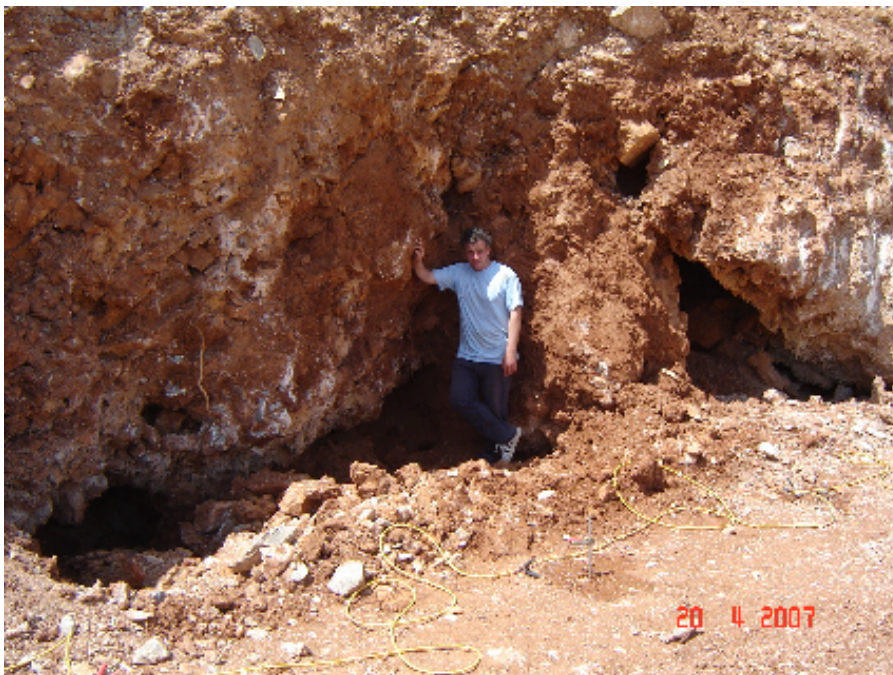
Φωτογραφία 17. Στη φωτογραφία απεικονίζονται τα έγκοιλα που εντοπίστηκαν στο πρανές του κάτω παταριού. Οι δομές έχουν ύψος περίπου 2.0 μέτρα.
