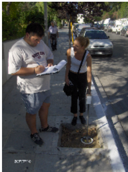
Φώτο. 2 Μέτρηση μαγνητικής επιδεκτικότητας με τον αισθητήρα MS2D.
