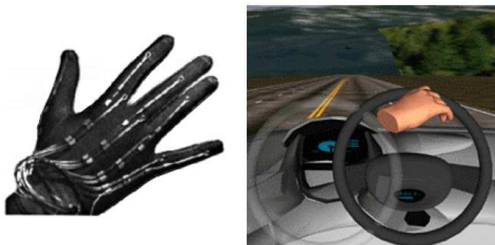
Εικόνα 2 Γάντι Αίσθησης και επίδραση στο εικονικό περιβάλλον (δύναμη στο τιμόνι)
