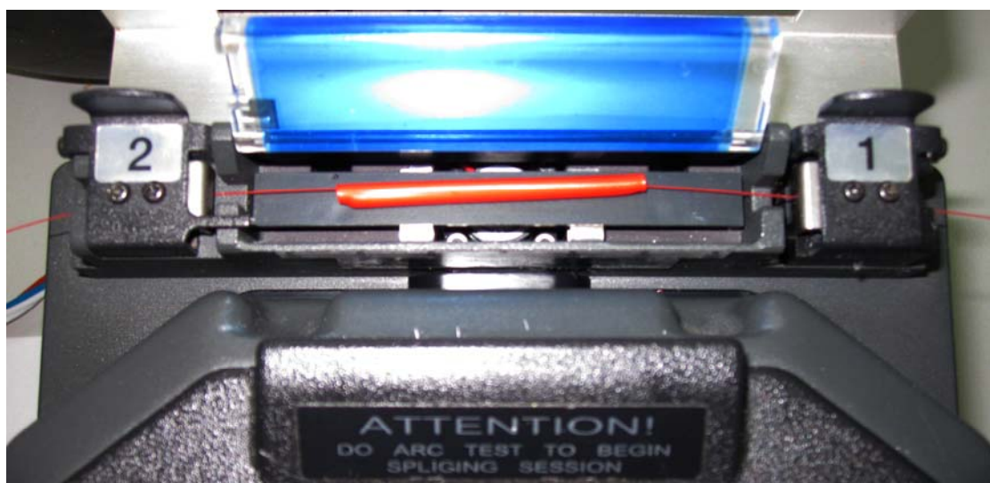
Εικόνα 9.14: Η θυρίδα εφαρμογής των θερμοσυστελλόμενων σωληνίσκων
