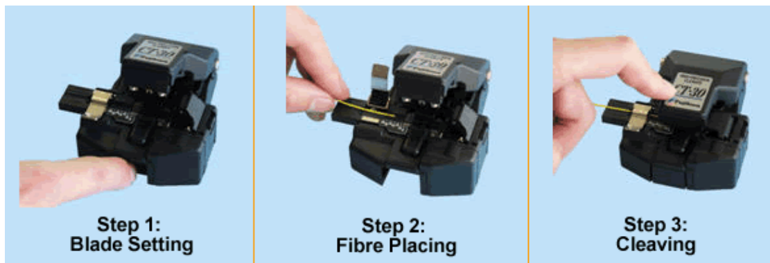
Εικόνα 9.5 : Τα βήματα της διαδικασίας κοπής της οπτικής ίνας.
