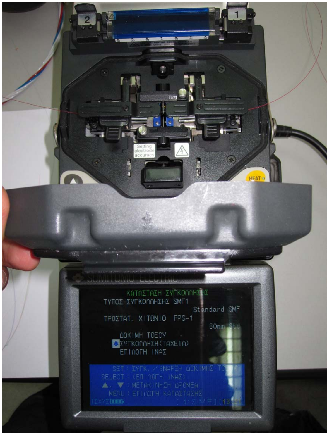
Εικόνα 9.8: Το fusion splicer της SUMIMOTO
