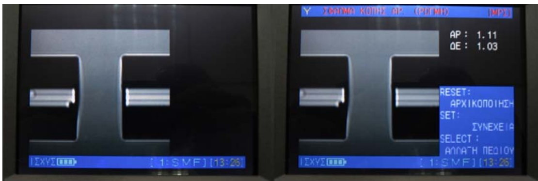
Εικόνα 9.11: Μήνυμα λάθους από το fusion splicer λόγω σφάλματος κοπής της ίνας
