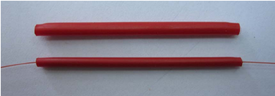
Εικόνα 9.15 : Ο θερμοσυστελλόμενος σωληνίσκος πριν και μετά την εφαρμογή
