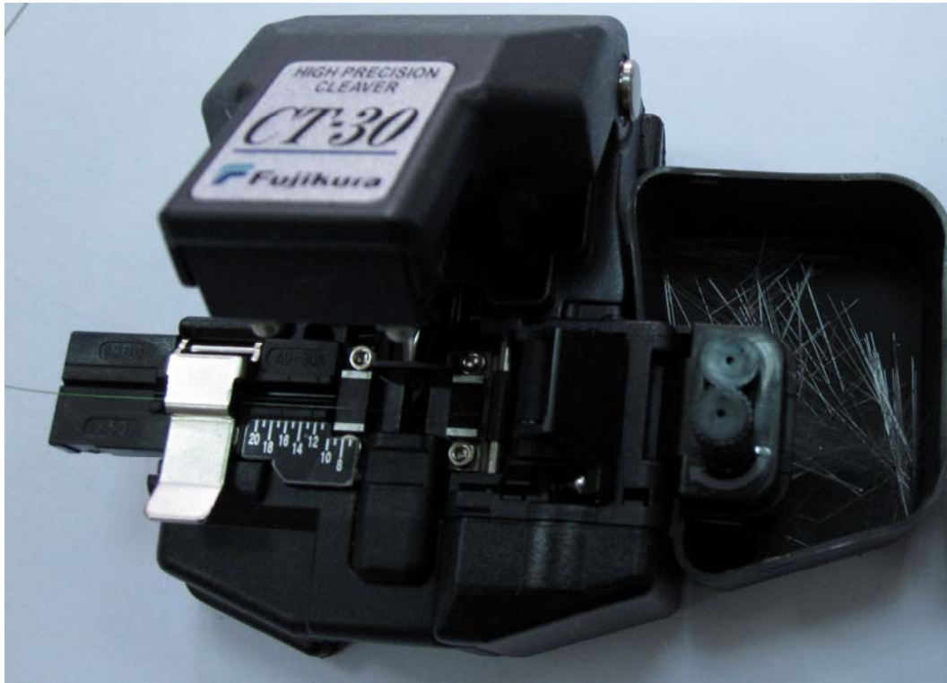
Εικόνα 9.6: Το μηχάνημα υψηλής ακρίβειας κοπής οπτικών ινών της FUJIKURA.
