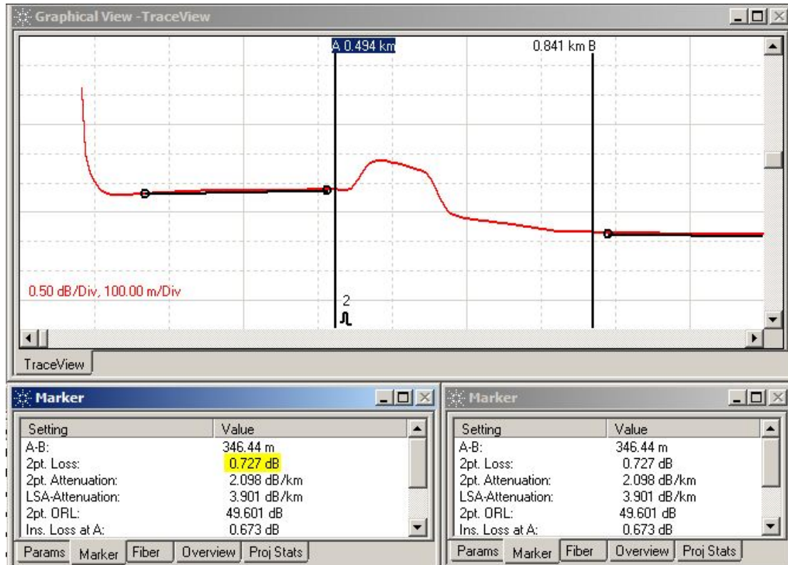
Εικόνα 9.22 : Γραφική παράσταση εξασθένισης οπτικής ίνας χωρίς κάμψη
