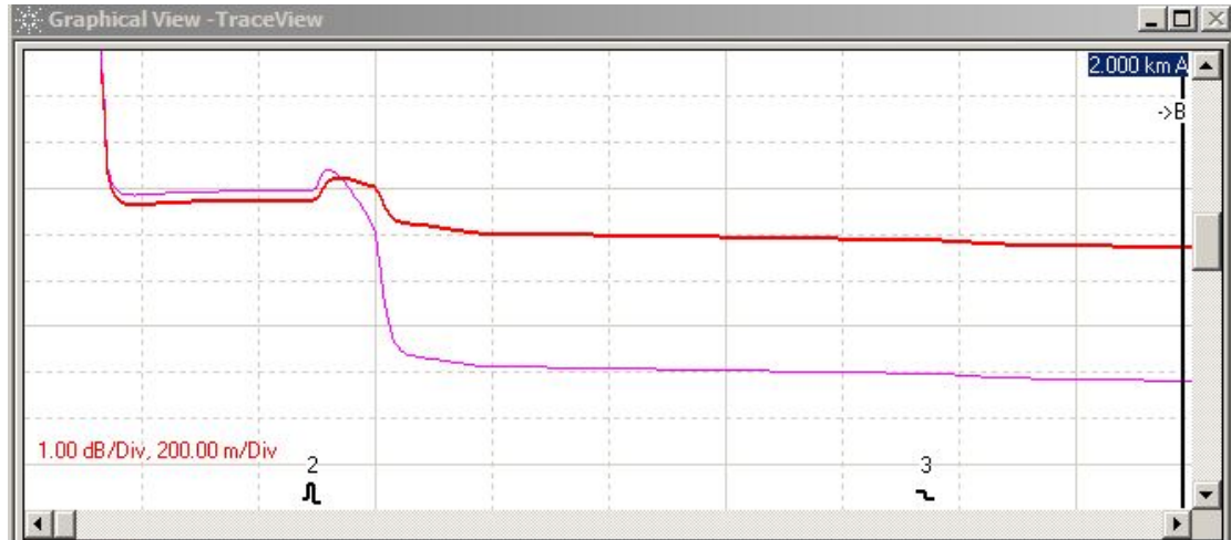
Εικόνα 9.25 : Σύγκριση γραφικών παραστάσεων εξασθένισης της ίνας με κάμψη(μωβ ίχνος) και χωρίς(κόκκινο ίχνος)
