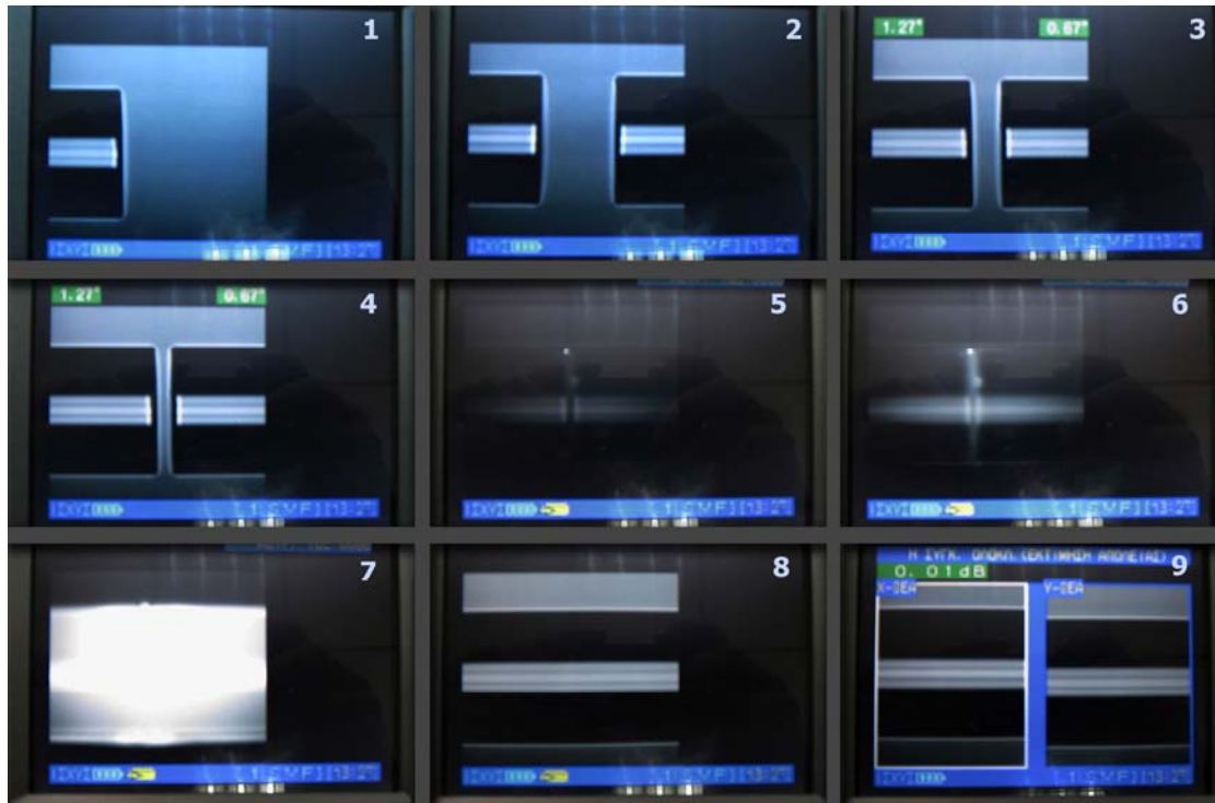
Εικόνα 9.9: Διαδοχικά στιγμιότυπα της οθόνης του fusion splicer από τα στάδια συγκόλλησης της οπτικής ίνας
