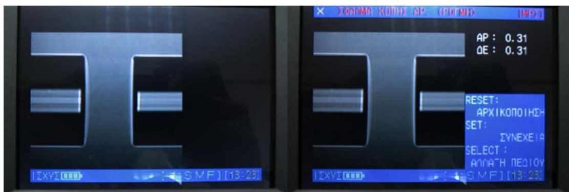
Εικόνα 9.12: Μήνυμα λάθους από το fusion splicer λόγω διαφοράς του τρόπου πεδίου
