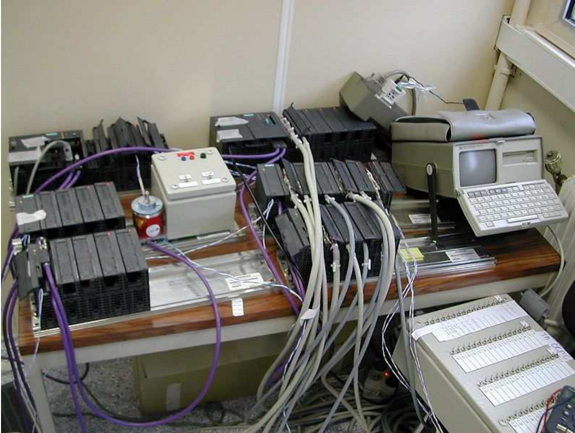
Εικόνα 8 PLC & input/output arrangements
