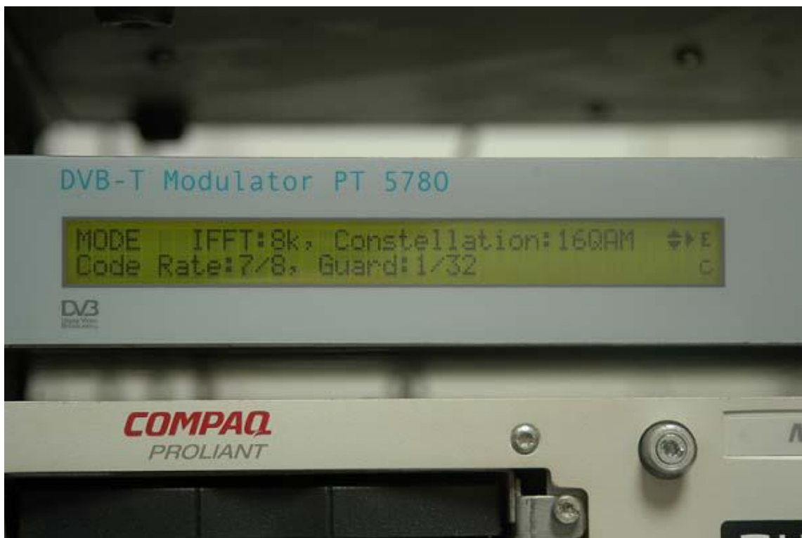
Σχήμα 13 Ο Διαμορφωτής COFDM που Παρουσιάζει τα Στοιχεία της Διαμόρφωσης
