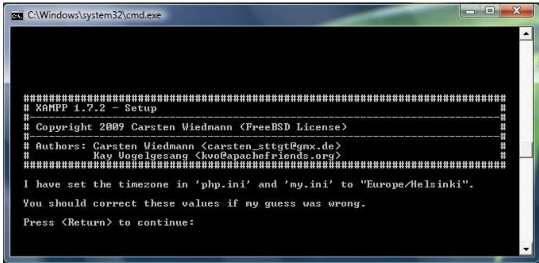
Εικόνα 16: Εγκατάσταση XAMPP. Βήμα 6 ο , ορισμός ζώνης ώρας
