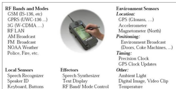
Εικόνα 2.1: Η σουίτα αισθητήρων του Cognitive Radio [2].
