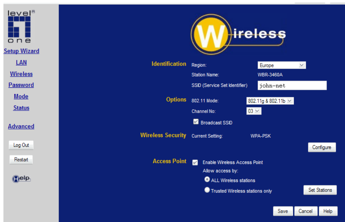
Εικόνα 113 Ρύθμιση του access point για εκπομπή SSID
