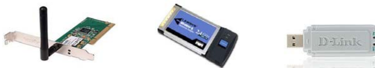
Εικόνα 1 Ασύρματες κάρτες δικτύου με διάφορες συνδεσμολογίες (PCMCIA, PCI και USB από αριστερά προς τα δεξιά)
