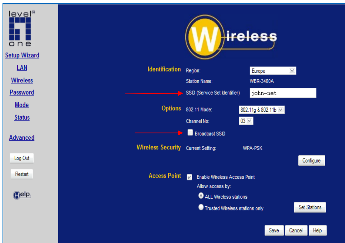
Εικόνα 111 Ρύθμιση του access point για μη εκπομπή SSID
