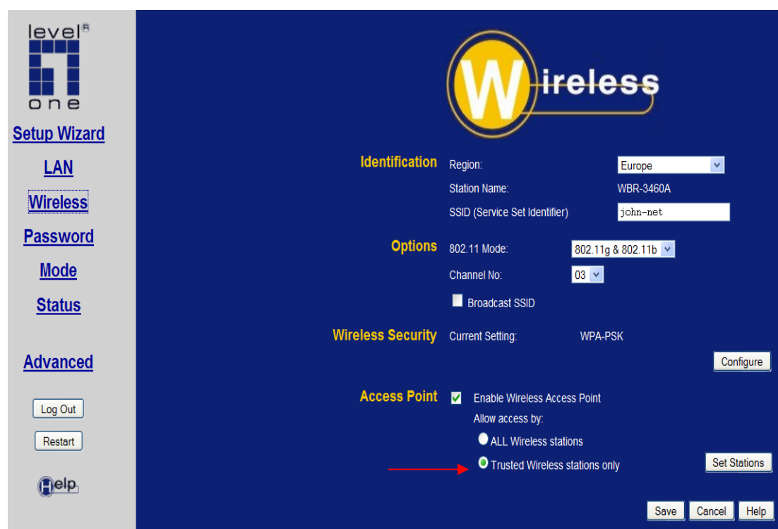
Εικόνα 91 Ρύθμιση σημείου πρόσβασης άλλου κατασκευαστή για MAC Filtering
