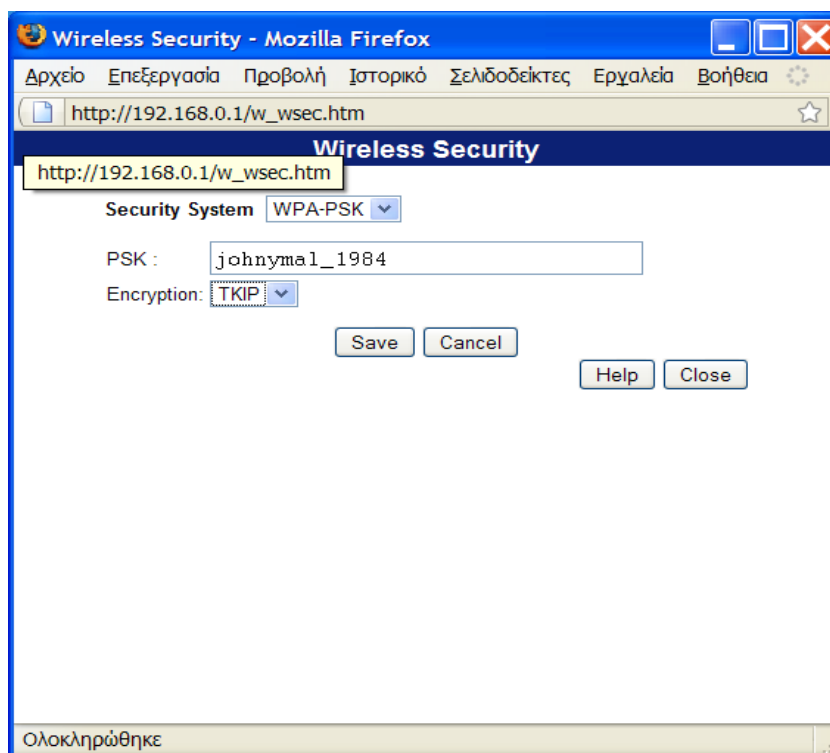
Εικόνα 38 Ρύθμιση του σημείου πρόσβασης για υποστήριξη WPA
