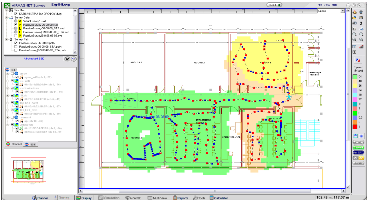
Εικόνα 5. Κάλυψη ορόφου Αιθ.8-9 από άλλα APs με βάση την ταχύτητα σύνδεσης (Mbps).
