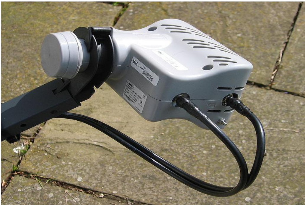
Σχήμα 2.5 Αμφίδρομο iLNB που χρησιμοποιείται από την ASTRA2Connect
