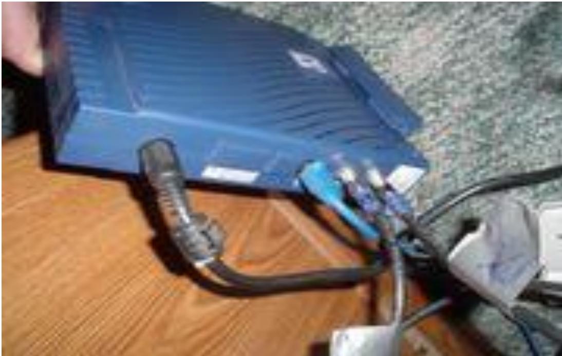
Σχήμα2.4 Το πίσω πάνελ ενός δορυφορικού μόντεμ, συνδέσεις με ομοαξονικό τόσο για τα εισερχόμενα και εξερχόμενα σήματα, και μια Ethernet θύρα για σύνδεση με το εσωτερικό δίκτυο.
