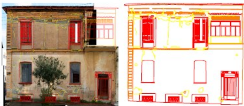
Εικόνα 23- Φωτογραμμετρική απόδοση και τελικό διάγραμμα όψης.
