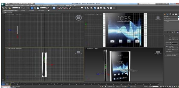
Εικόνα 78 Εμφάνιση plane με φωτογραφία του μοντέλου που θέλουμε να δημιουργήσουμε, για να χρησιμοποιηθεί ως πατρών στην σχεδίαση του μοντέλου.
