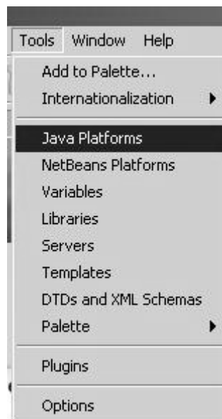
Εικόνα 177: Το πρώτο βήμα για την ενσωμάτωση μιας πλατφόρμας Java στο IDE NetBeans
