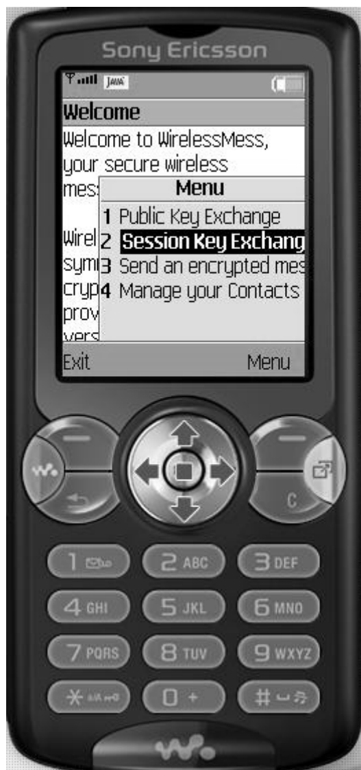
Εικόνα 97: Το κεντρικό μενού της εφαρμογής και η επιλογή για την αποστολή των στοιχείων που δημιουργούν το session key
