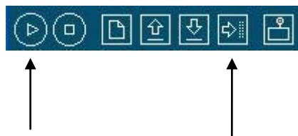
Εικόνα 9. 3: Λειτουργίες Compile/Verify και Upload στο Arduino IDE.
