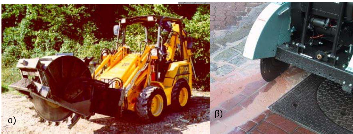
Σχήμα 34 Μηχάνημα για διάνοιξη α) μικροτάφρου και β) μικροτάφρου «ελαφρού τύπου»
