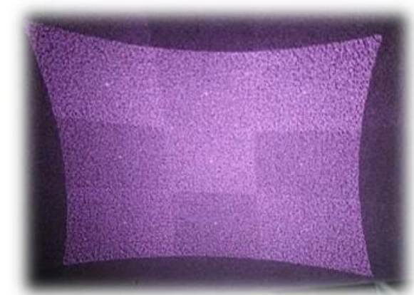
Εικόνα 4 - Η δομή υπέρυθρων από τον πομπό του Kinect
