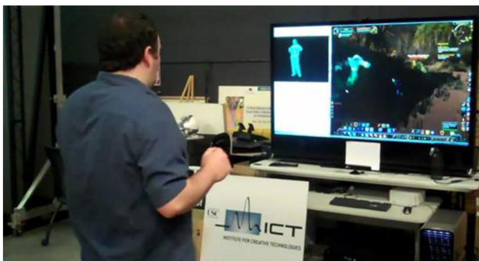
Εικόνα 25 - Χρήση του Kinect μέσω του FFAST ως είσοδο για το παιχνίδι World of Warcraft (κανονική συσκευή εισόδου: πληκτρολόγιο)
