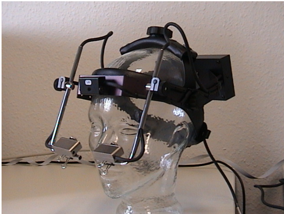
Εικόνα 19: Σύστημα καταγραφής της οφθαλμικής κίνησης, προσαρμοσμένο σε ομοίωμα κεφαλής.
