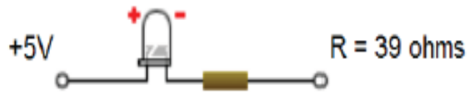
Εικόνα 28 : Ένα απλό κύκλωμα LED
