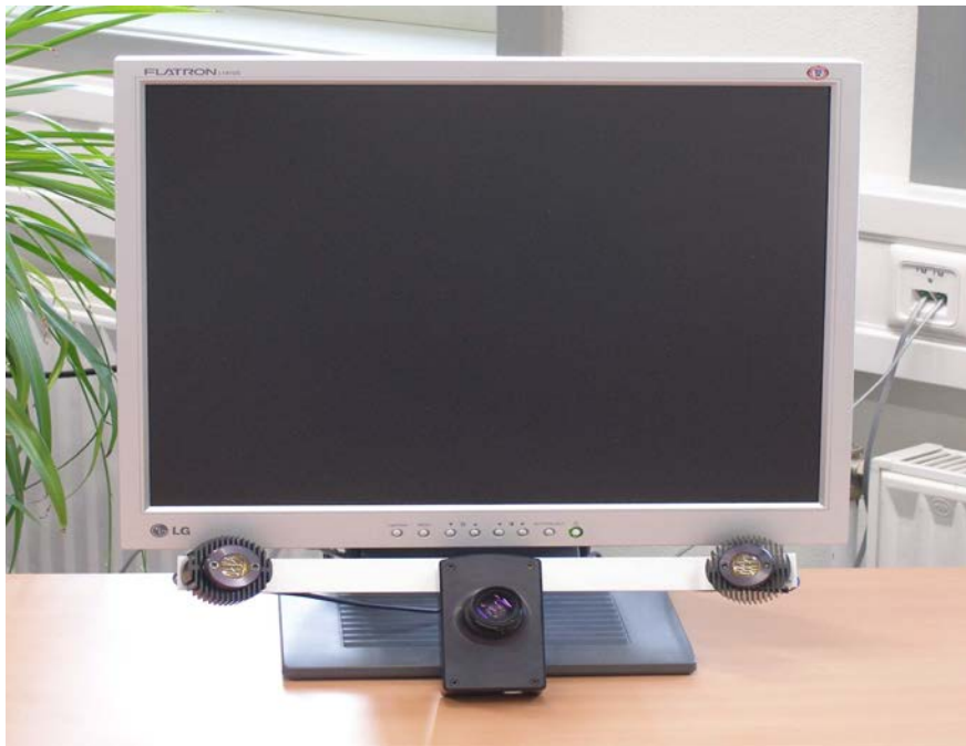
Εικόνα 25 : Τα μέρη του συστήματος, η κάμερα και τα δυο υπέρυθρα.
