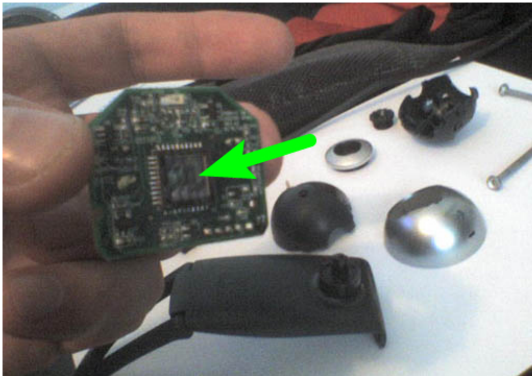
Εικόνα 44 : Το σημείο που βρίσκεται το φίλτρο υπερύθρων
