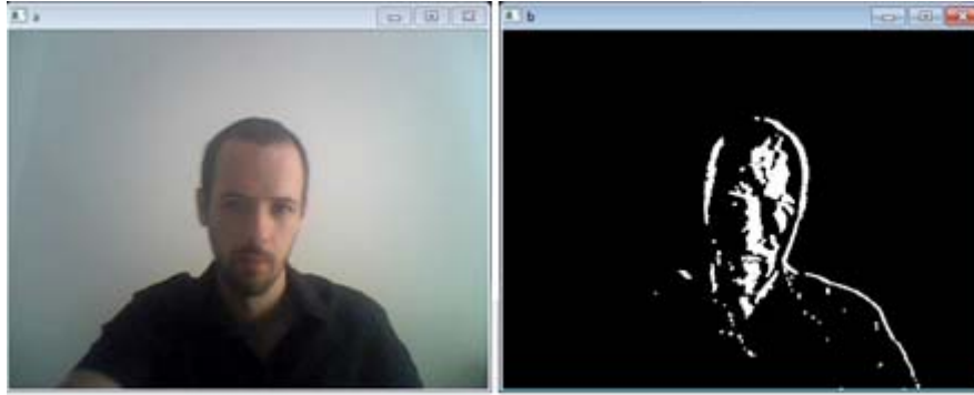
5-9 Blink detection. Ανίχνευση κίνησης που δεν οφείλεται σε ανοιγόκλεισμα ματιών. Για τον αποκλεισμό των κινήσεων που δεν οφείλεται σε ανοιγόκλεισμα ματιών τα παραγόμενα contours θα πρέπει ελέγχονται ως προς την απόσταση τους την υψομετρική διαφορά τους και το μέγεθος τους.
