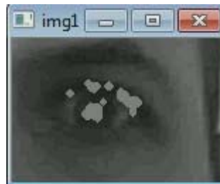
6-9 Συνδυασμός ανίχνευσης κύκλων και της εύρεσης της κόρης του ματιού. Μηδέν επιστρεφόμενοι κύκλοι από τη cvHoughCircles() . Το πρόγραμμα θεωρεί ότι δεν υπάρχει ίριδα.
