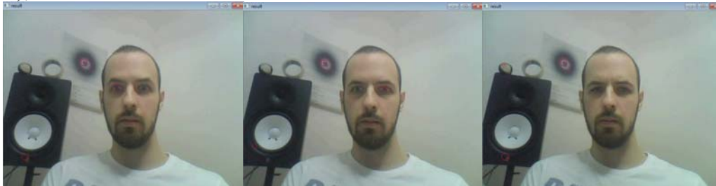
4-18 Εύρεση ίριδας χωρίς περιορισμό. Τρίτο σετ ορισμάτων σε τεχνητό φως και φόντο με στρογγυλά αντικείμενα. Η ίριδα μπορεί να βρεθεί αλλά επιστρέφονται και κύκλοι που δεν είναι ίριδα.
