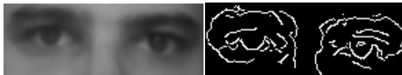
3-13 cvHoughCircles() . Canny Edge Detection. Η δεύτερη εικόνα είναι το αποτέλεσμα ανίχνευσης ακμών.
