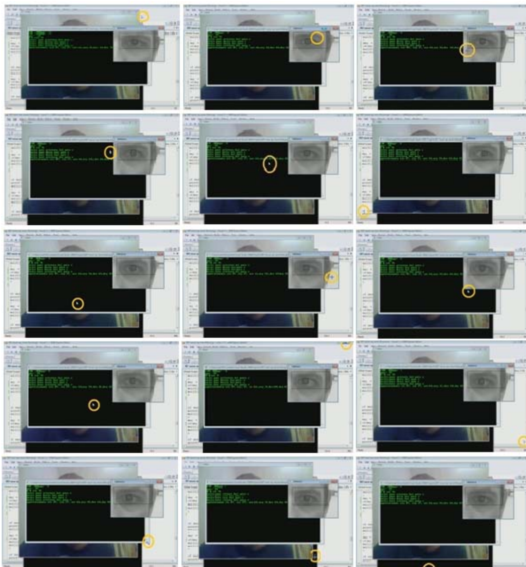
7-15 Κίνηση δείκτη με την ίριδα. Κρατώντας το κεφάλι σταθερό είναι δυνατή η κίνηση του δείκτη του ποντικιού ανάλογα με το που κοιτά ο χρήστης.
