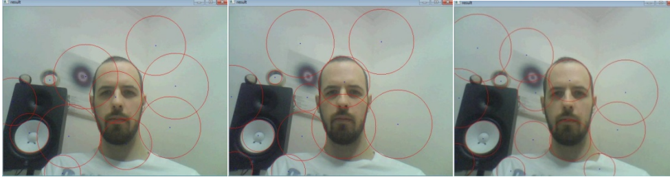
4-16 Εύρεση ίριδας χωρίς περιορισμό. Πρώτο σετ ορισμάτων σε τεχνητό φως και φόντο με στρογγυλά αντικείμενα. Μεγάλοι κύκλοι, ψεύτικοι.
