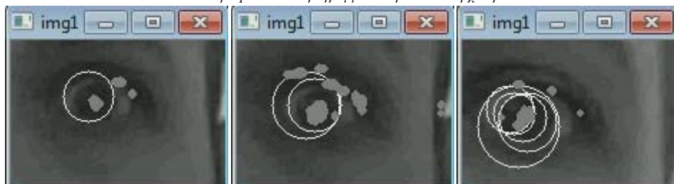
6-11 Συνδυασμός ανίχνευσης κύκλων και της εύρεσης της κόρης του ματιού. Εύρεση κύκλων με κέντρο μη σκοτεινό σημείο, το πρόγραμμα θεωρεί ότι δεν υπάρχει ίριδα.
