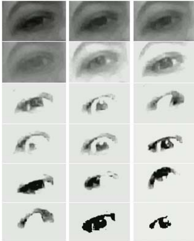
6-3 Έφαρμογή φίλτρου contrast-brightness. Με την εφαρμογή του φίλτρου είναι δυνατός ο διαχωρισμός τις ίριδας από την υπόλοιπη εικόνα, η ίριδα όμως αλλοιώνεται.
