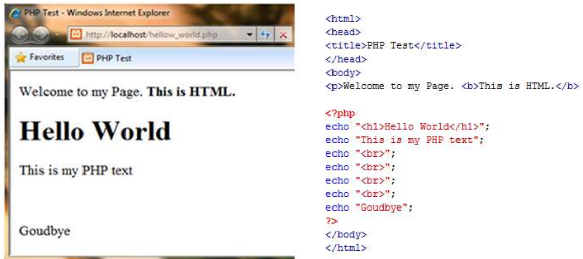
Εικόνα 2.10: Ενσωμάτωση PHP στην HTML
