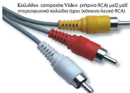
Εικόνα 12: Καλώδια Μεταφοράς Αναλογικού Βίντεο-Ήχου
