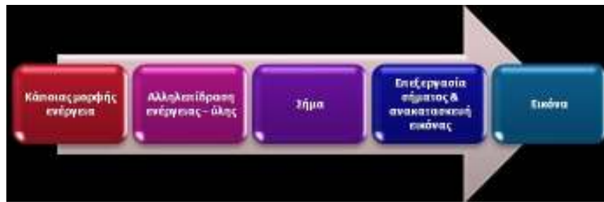
Εικόνα 2 2 Γενικό μοντέλο ολοκληρωμένου συστήματος με επεμβατική απεικόνιση και ανακατασκευή εικόνας
