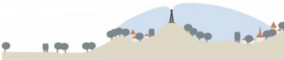
Σχήμα 2: Παράδειγμα της περιοχής κάλυψης ενός σταθμού βάσης
