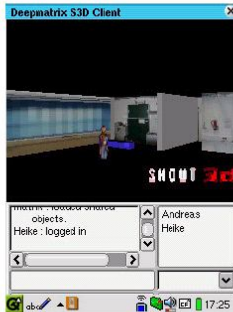
Εικόνα 6.4 Συνεργατικό περιβάλλον εικονικής πραγματικότητας σε Sharp Zaurus PDA, 206 Mhz ARM processor, embedded Linux, 240x320 pixel
