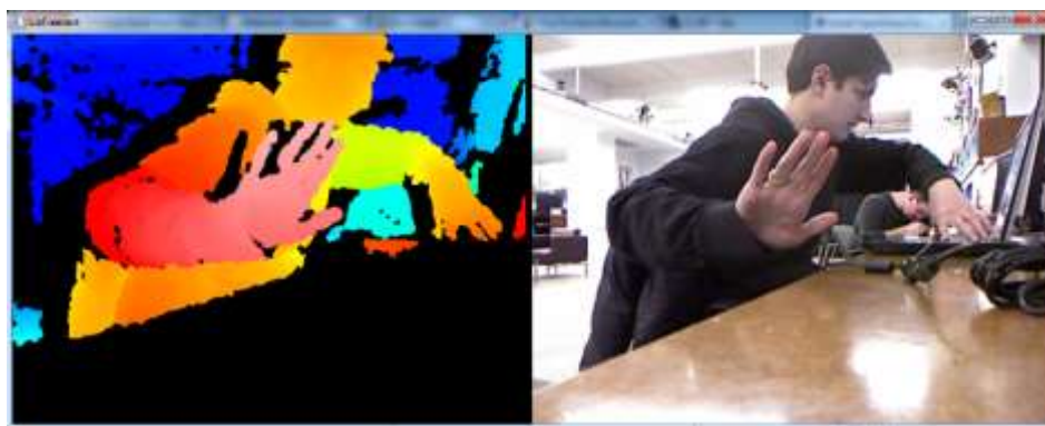
Εικόνα 17 - Χάρτης βάθους και RGB κάμερα με τη χρήση του Libfreenect
