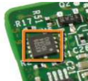
Εικόνα 11 - Το Επιταχυνσιόμετρο του Kinect.
