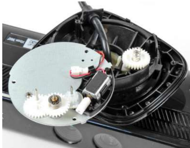
Εικόνα 15 - Η μηχανοκίνητη βάση του Kinect
