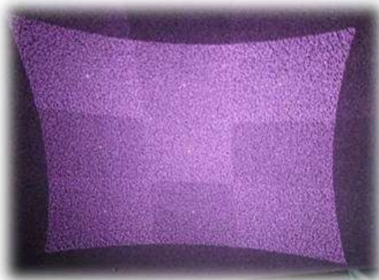
Εικόνα 6 - Η δομή υπέρυθρων από τον πομπό του Kinect
