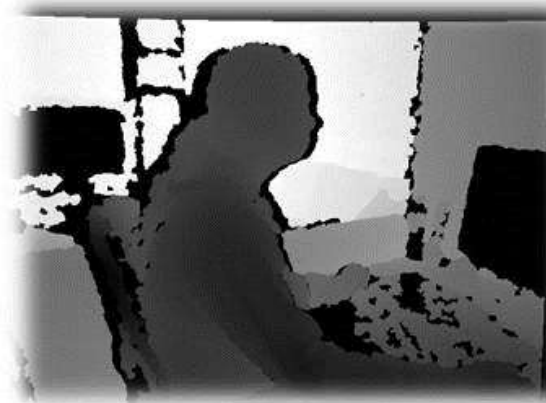
Εικόνα 7 - Εικόνα βάθους από το Kinect
