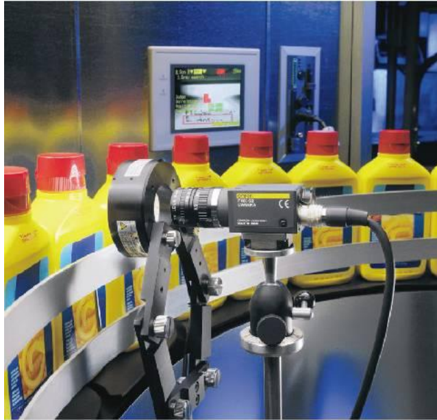
Εικόνα 14: Σύστημα τεχνητής όρασης που επιθεωρεί μπουκάλια
