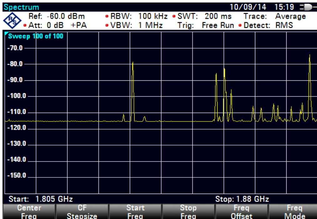
Εικόνα 38: Μέτρηση DCS 1800 για πόλωση Z
