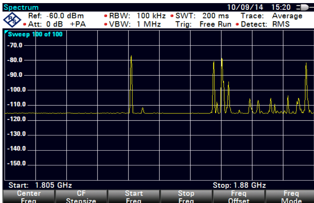
Εικόνα 37: Μέτρηση DCS 1800 για πόλωση Y
