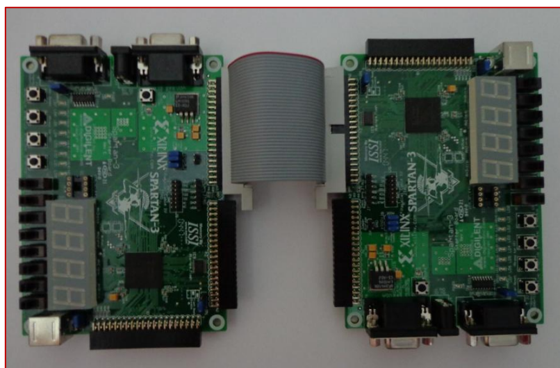
Εικόνα 4 - Δύο boards συνδεδεμένα με καλωδιωταινία
