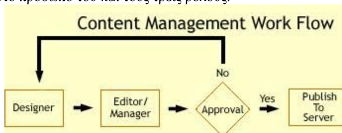
Εικόνα 2 -Τυπικό διάγραμμα ροής εργασίας σε ένα CMS
