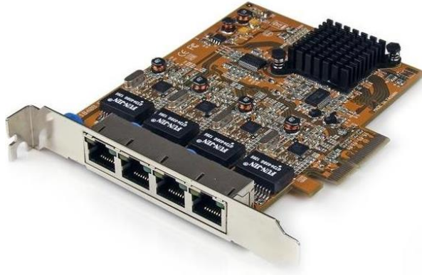
Εικόνα 2.5. Κάρτα δικτύου Ethernet (PCI Express)
