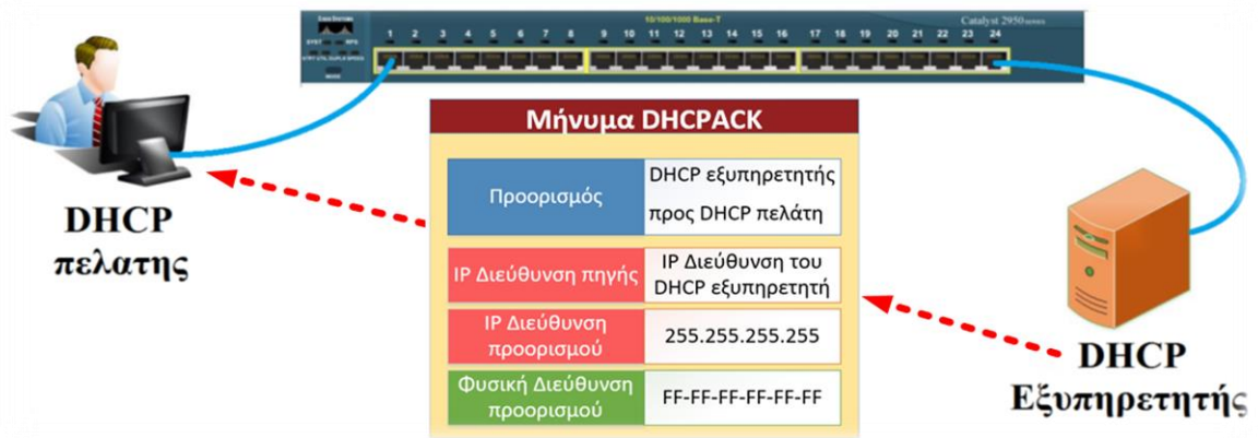
Εικόνα 2.32. Παράδειγμα αποστολής μηνύματος DHCPACK
