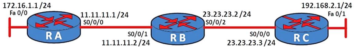
Εικόνα 2.54. Τοπολογία δικτύου με τρεις δρομολογητές
