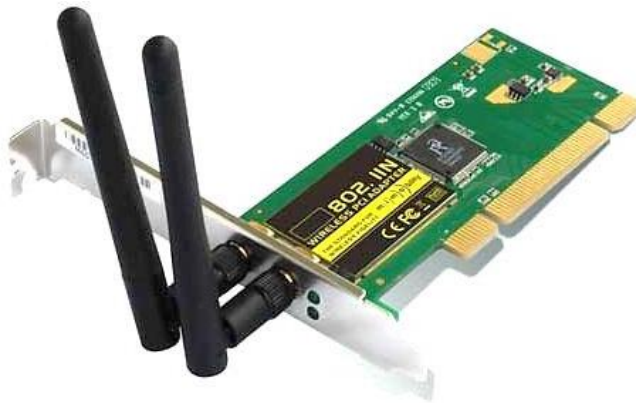
Εικόνα 2.6. Ασύρματη κάρτα δικτύου (PCI)
