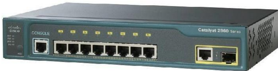
Εικόνα 2.9. Συσκευή switch επιπέδου ζεύξης της CISCO μοντέλο Catalyst 2960
