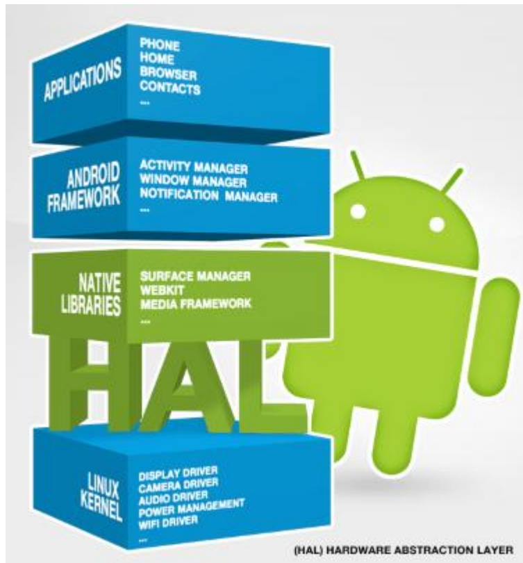
Εικόνα 8: Android OS Architecture
