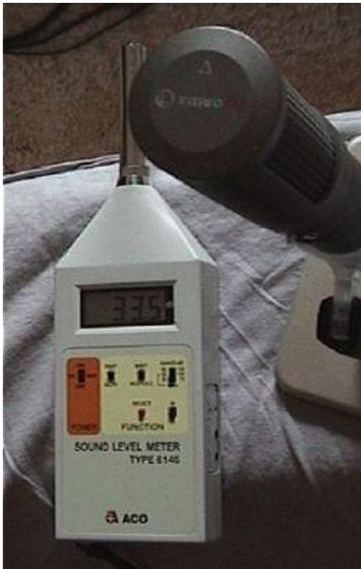
Εικόνα 102:Ντεσιμπελόμετρο(όργανο μέτρησης έντασης ήχου)_Μικρόφωνο
