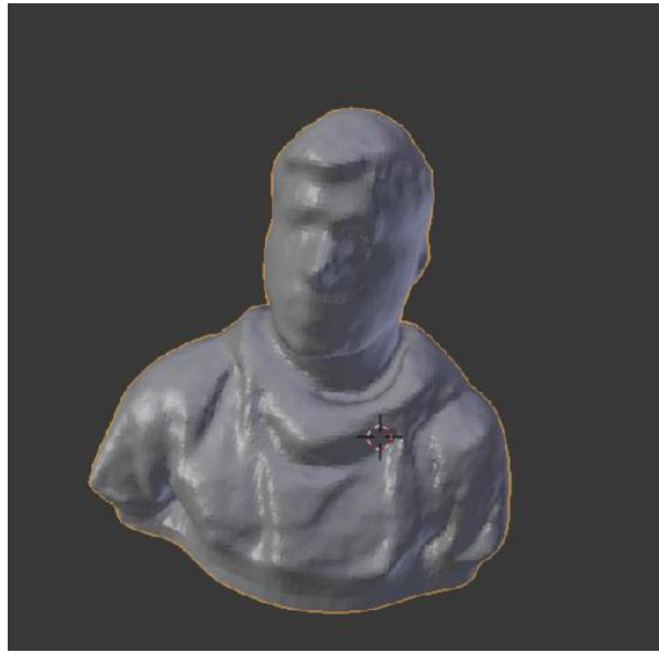
Εικόνα 28 – Poisson-Mesh (ανακατασκευή επιφάνειας)
