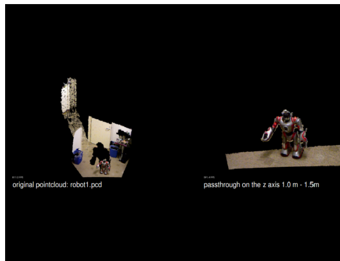
Εικόνα 21 – pass through (πριν και μετά)
