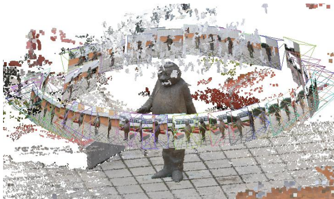
Εικόνα 56 - Παράδειγμα διαδικασίας σάρωσης φωτογραμμετρικής εφαρμογής VisualSFM
