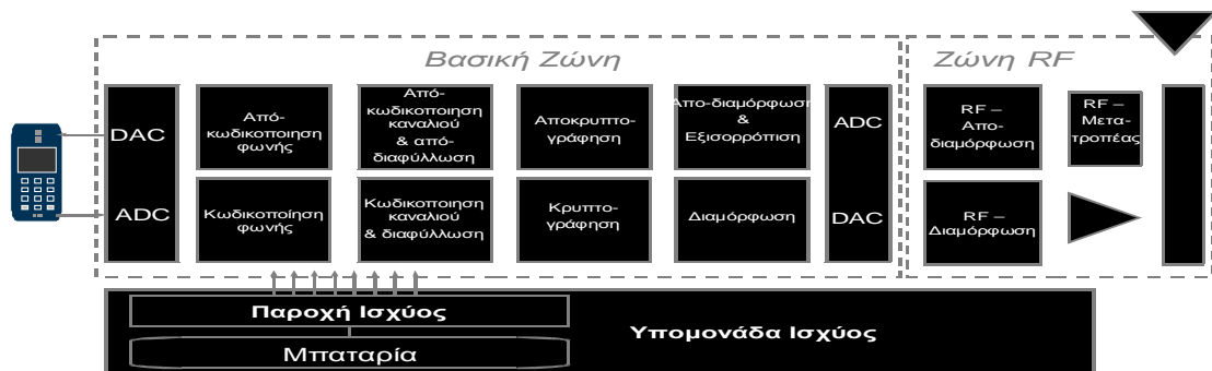
Σχήμα 1.2: Διάγραμμα λειτουργίας ενός πομποδέκτη
