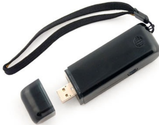
Εικόνα 3: USB συσκευή παθητικής παρακολούθησης, http://www.gpstrackstick.com/
