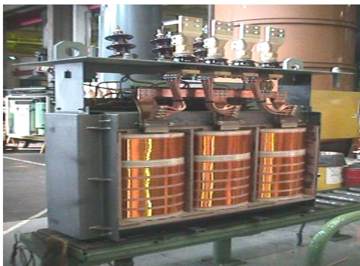
Σχήμα 5.12: Μετασχηματιστής άμορφου πυρήνα από μέσα 7
