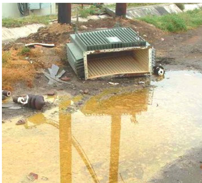
Σχήμα 2.16: Ρύπανση από κατεστραμμένο Μ/Σ διανομής.
