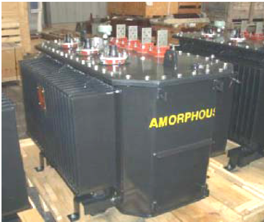
Σχήμα 5.10: Τριφασικός Μ/Σ διανομής άμορφου πυρήνα, 400kVA, 15,4/0,42kV, 50Hz
