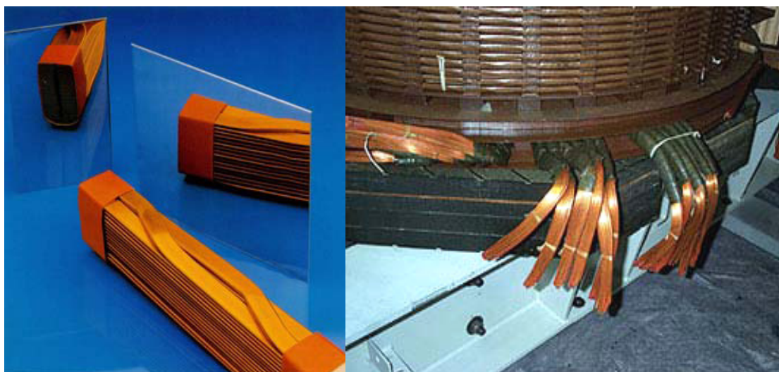
Σχήμα 5.5: Συνεχής αντιμετάθεση αγωγών (αριστερά) και εφαρμογή της συνεχούς αντιμετάθεσης αγωγών σε έναν μεγάλο μετασχηματιστή (δεξιά).
