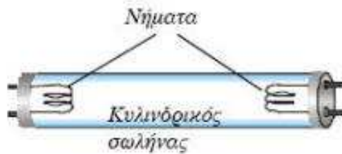
Εικόνα 3-1: Ο λαμπτήρας φθορισμού και τα τμήματα από τα οποία αποτελείται.
