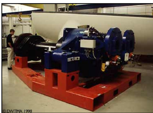
Σχήμα 4.4 κιβώτιο ταχυτήτων για μία ανεμογεννήτρια του 1.5MW
