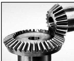
Σχήμα 4.3 Λοξοτομημένα μηχανικά δόντια που συνήθως χρησιμοποιούνται στα κιβώτια ταχυτήτων.
