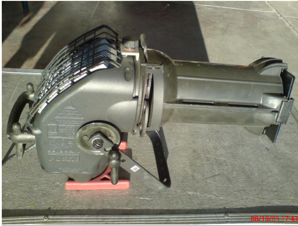
Φωτ. 3.11: Θεατρικό φωτιστικό σώμα SELECON τύπου Profile(1000 W)
