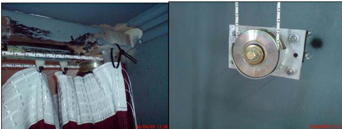
Φωτ. 1.40-41 : Μηχανισμός κίνησης με σχοινί ( άνοιγμα - κλείσιμο )
