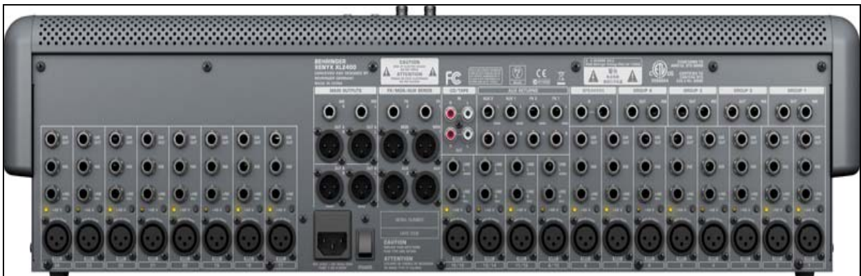
Η πίσω όψη της κονσόλας μίξης ήχου ( είσοδοι - έξοδοι )
