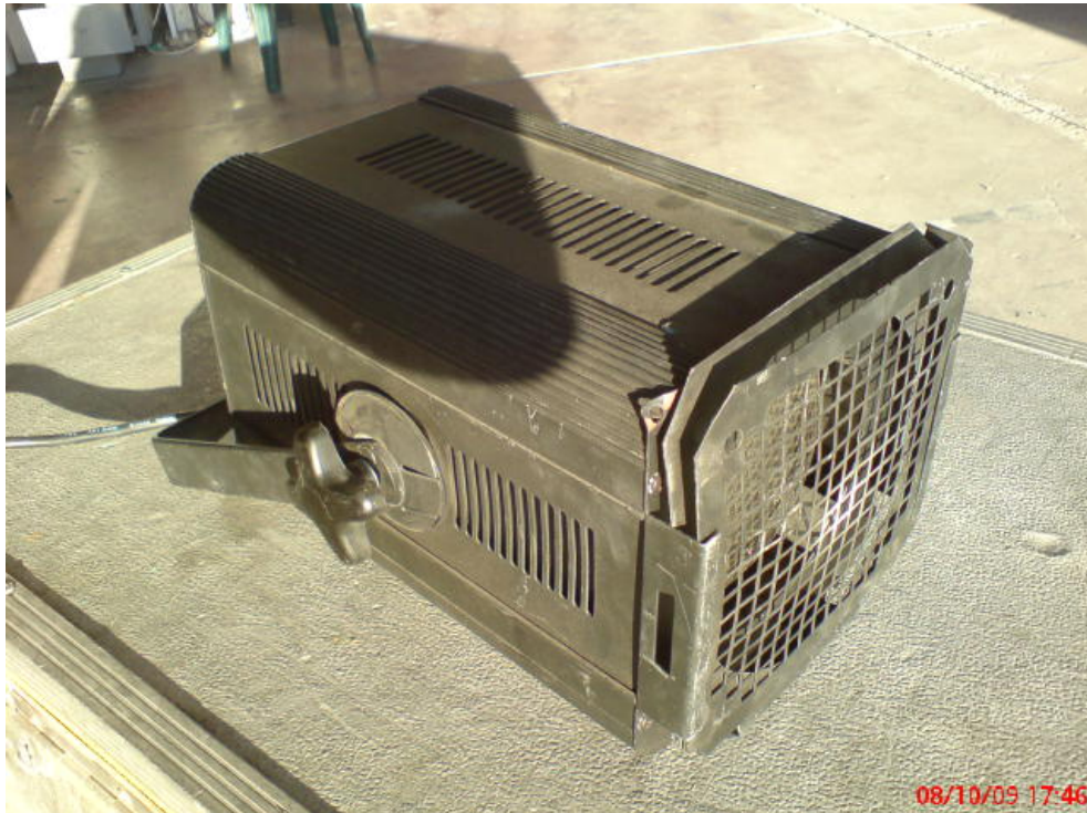
Φωτ. 3.9: Θεατρικό φωτιστικό σώμα τύπου PC (1000 W)
