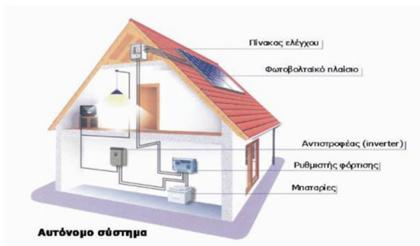
Εικόνα 13: Αυτόνομο Φωτοβολταϊκό Σύστημα <nalvi.gr>
