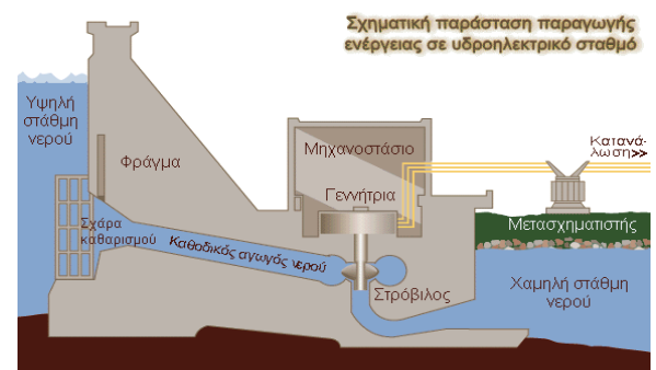
Εικόνα 38: Υδροηλεκτρικό σταθμός <sfvang.com>
