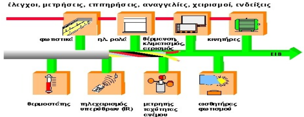
Εικόνα 51: Καλωδίωση EIB/KNX <kondopoulos.gr>
