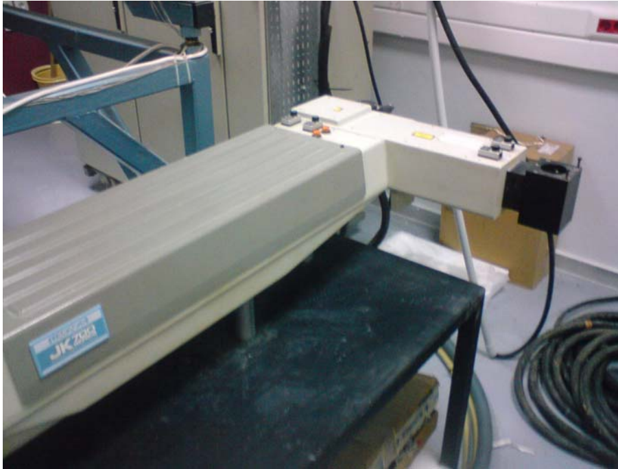
Σχήμα 4.10 Καθρέφτης που στρέφει την δέσμη λέιζερ
