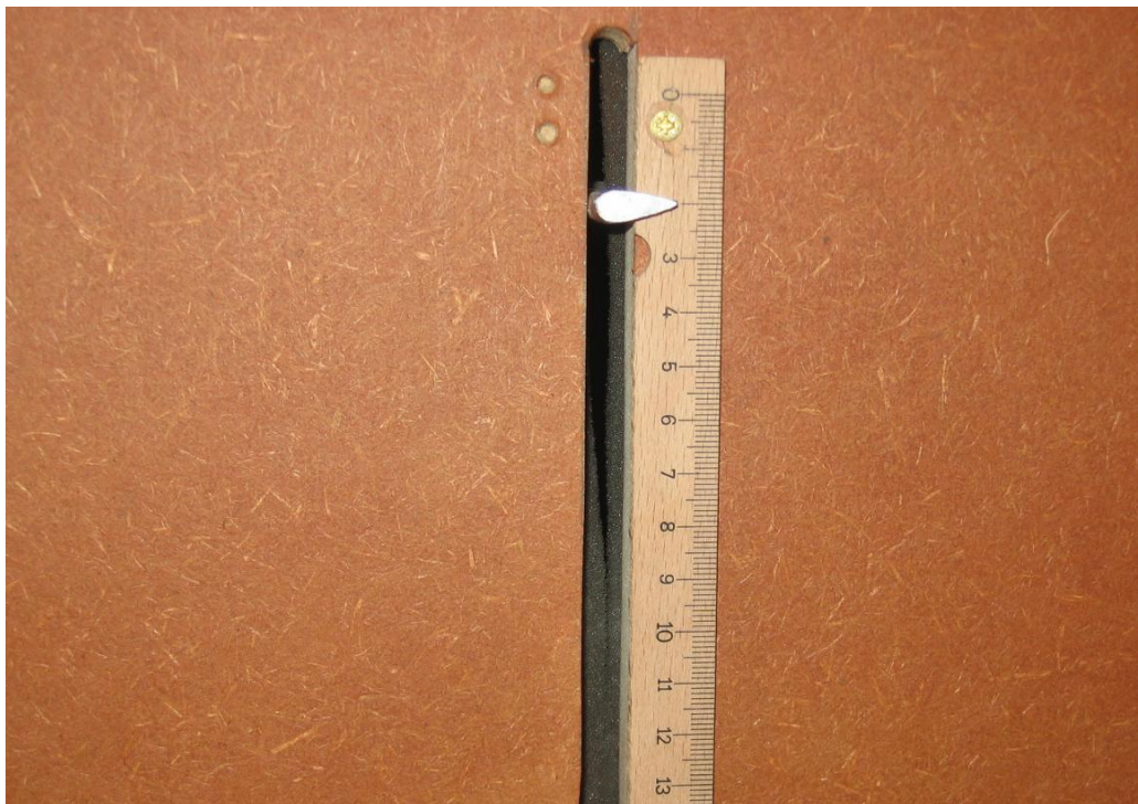
Εικόνα 14. Σύστημα ένδειξης απόστασης μεταξύ των ακίδων.
