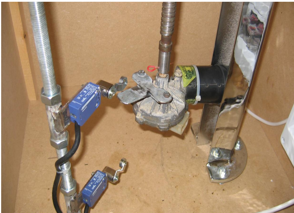
Εικόνα 9. Τερματικοί διακόπτες, διακρίνεται επίσης και ο τρόπος σύνδεσης του κινητήρα με τον ατέρμονα.
