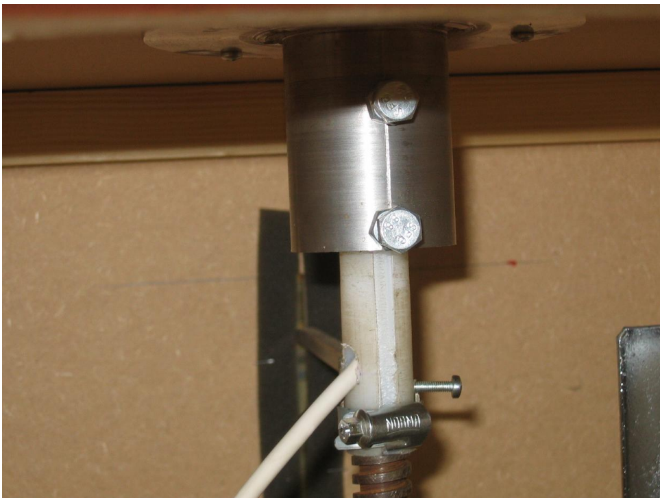
Εικόνα 5. Βάση και οδηγός της κάτω ακίδας.
