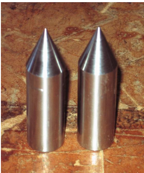
Εικόνα 20. α. Ηλεκτρόδια οβάλ β. Ηλεκτρόδια με γωνία μύτης 120^\circ γ. Γωνία μύτης 90^\circ δ. Γωνία μύτης 60^\circ ε. Γωνία μύτης 30^\circ στ. Σφαίρα
