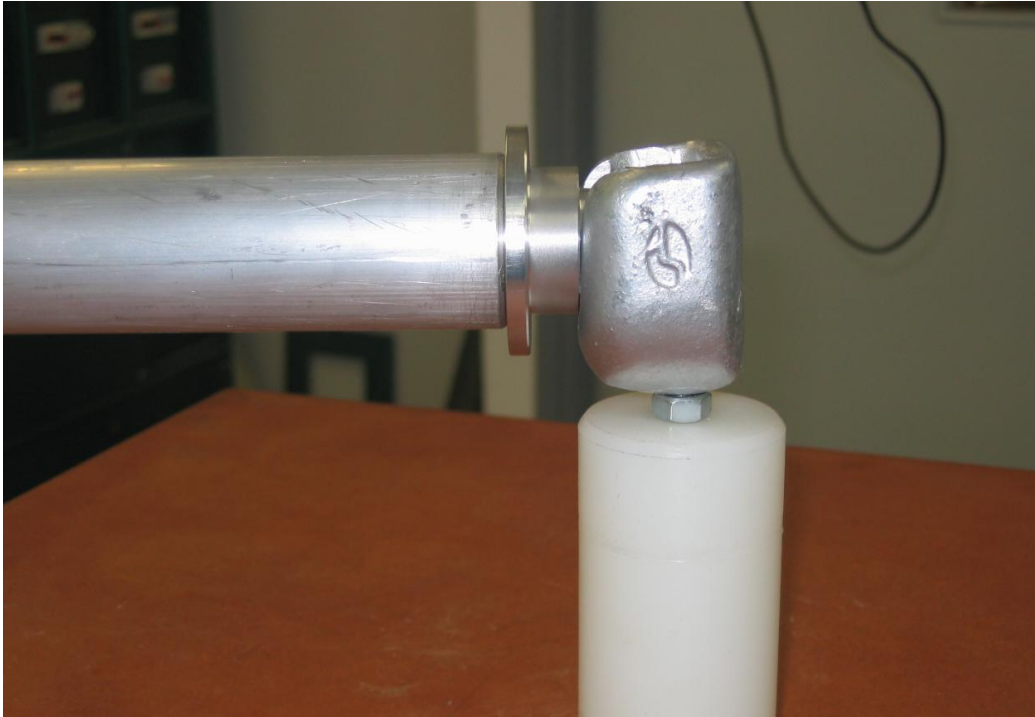
Εικόνα 16. Σύνδεση της πάνω ακίδας με την διάταξη του εργαστηρίου.
