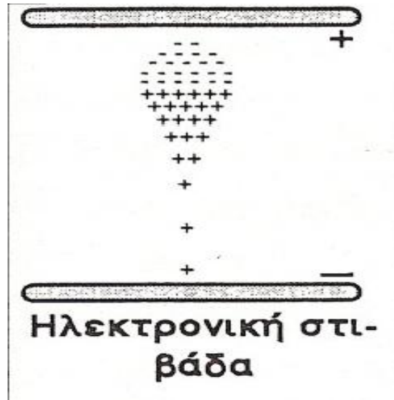
Σχήμα 3.2 (Πηγή: Τεχνολογία των Υψηλών Τάσεων-Στασινόπουλου )
