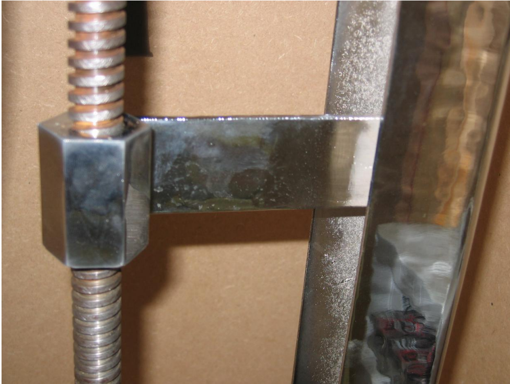
Εικόνα 7. Ατέρμονας περικόχλιο και οδηγός κινητήρα.
