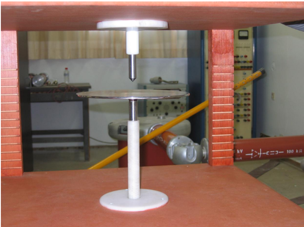
Εικόνα 28. Ηλεκτρόδιο πλάκας σε συνδυασμό με ακίδα 90°.
