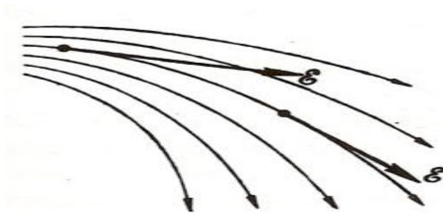
Σχήμα 2.1 Η ένταση του πεδίου είναι εφαπτόμενη σε κάθε σημείο των δυναμικών γραμμών.(Πηγή: Γενική Φυσική-Αλεξόπουλου Μαρίνου )
