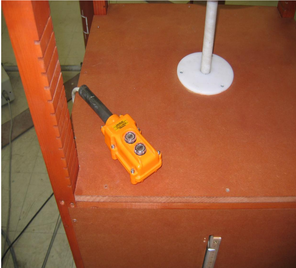
Εικόνα 15. Χειριστήριο ελέγχου κινητήρα.
