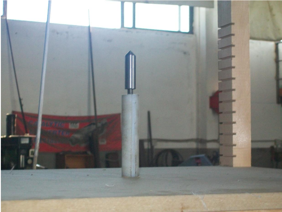
Εικόνα 6. Βάση και οδηγός της κάτω ακίδας.
