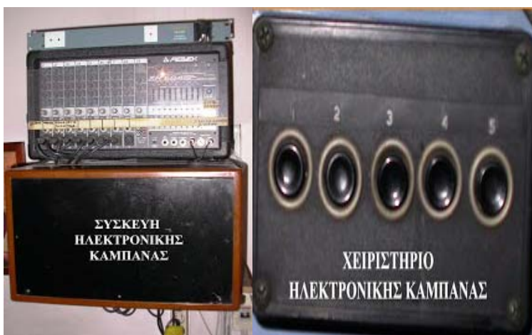
Εικόνα 49: Συσκευή ηλεκτρονικής καμπάνας 48 . Εικόνα 50: Χειριστήριο ηλεκτρονικής καμπάνας 49 .
