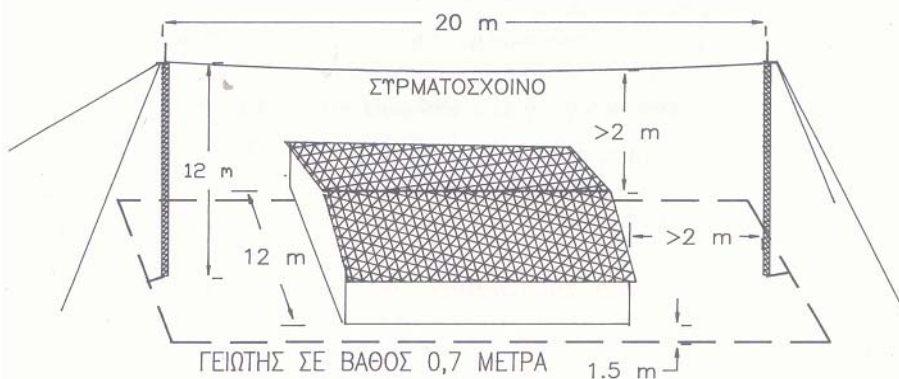
Σχήμα 12.5: Τεταμένο συρματοσχοίνο για αντικεραυνική προστασία.
