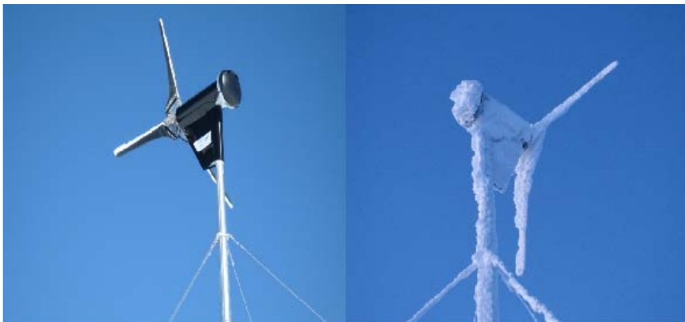
Εικ. 7-1 Μικρής έκτασης παγοποίησης (I) στην αριστερή εικόνα και μεγάλης έκτασης παγοποίησης (II) στην δεξιά εικόνα.
