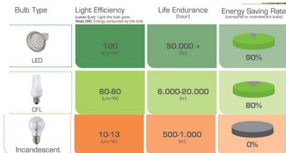
Εικ. 3-45 : Σύγκριση σε ενεργειακή απόδοση, διάρκεια ζωής και ποσοστό εξοικονόμησης ενέργειας μεταξύ λαμπτήρων LED, CFL και πυρακτώσεως (incandescent).
