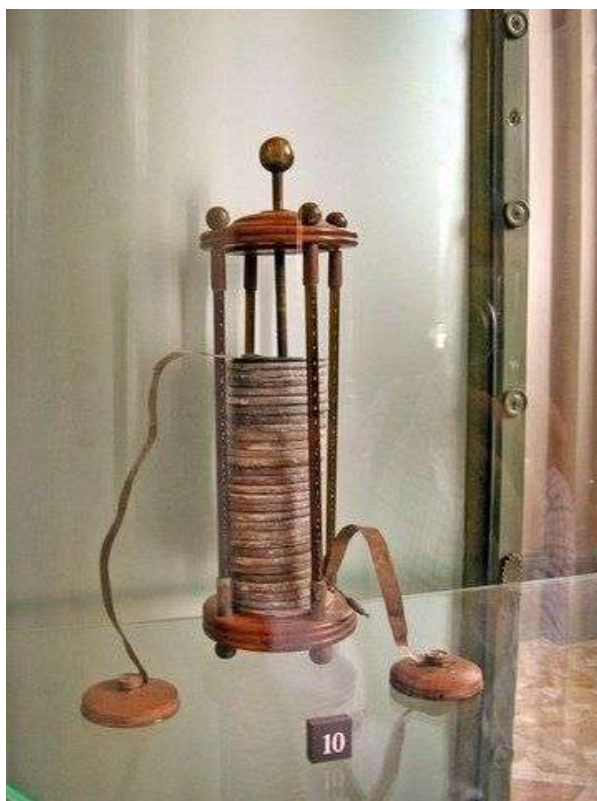
Εικόνα 2-7: Ηλεκτρική στήλη ή βολταϊκός σωρός
