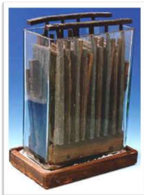
Εικόνα 2-15: Η μπαταρία μολύβδου-οξέος του Planté.
